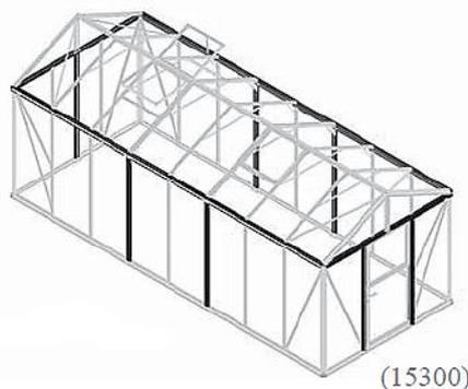
Do drážek dvou profilů 7006 zaveďte do každé drážky dva šrouby 7052 a zajistěte je matkami 7053 (2.10). Tady budete později pomocí styčného plechu upevňovat boční stěny. Vezměte profily 7006, 7014 a 7045 a namontujte je pomocí šroubů 7052 a matek 7053 na spodní rám (2.2 – 2.5). Profil 7006 na zadní stěně nepotřebuje žádné jisticí šrouby. Spojte boční profily 7006 a rohový profil 7007 - viz tabulka 2.1 (obr. 2.7 – 2.10). Dejte pozor na dodržení montážní hrany ( 2.8)
