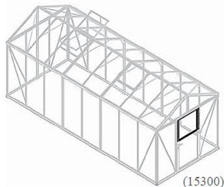
Do profilů 7017 a 7018 zaveďte po šroubu 7052 s matkou 7053. Smontujte základní rám horních dveří – ten sestává z profilů 7017, 7018 a 2x 7022 – pomocí šroubů 7054 a spec. šroubů 7055 (6a.1). Upevněte spodní krycí profil 7024 dolů (6a.2) a horní 7025 šrouby 7057 a šrouby 7052 s matkami 7053 (6a.4). Natáhněte těsnění dveří 7083 do horní hrany dveří (6a.5). Našroubujte západku 7085 šrouby 7087 na svislý dveřní profil 7018 /6a.6) a závěs dveří 7066 na svislý profil 7017 pomocí šroubů 7088 (6a.7)
