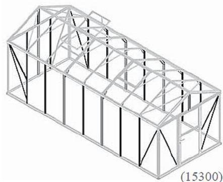
Vezměte 8/10 (podle modelu 11500/15300) svislé profily 7005 a zaveďte do drážky pro šroub 2 šrouby 7052 a zajistěte je lehce matkami 7053. Zde bude později ukotven styčný plech 7063 ukotvení boční stěny. Montujte podle kroku 3 připravené profily na stěnu. Na zadní stěnu namontujte 2 profily 7005 bez šroubů. Následně upevněte styčný plech 7063 na připravený profil 7005 a 7006 na boční stěnu (3.1, 3.2, 3.4, 3.5). Přesnou pozici (výšku) styčného plechu nastavíme později.
